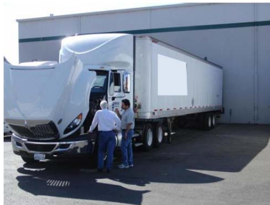
STAA 48 feet (STAA Truck Tractor-Semitrailer) FHWA Class 9
